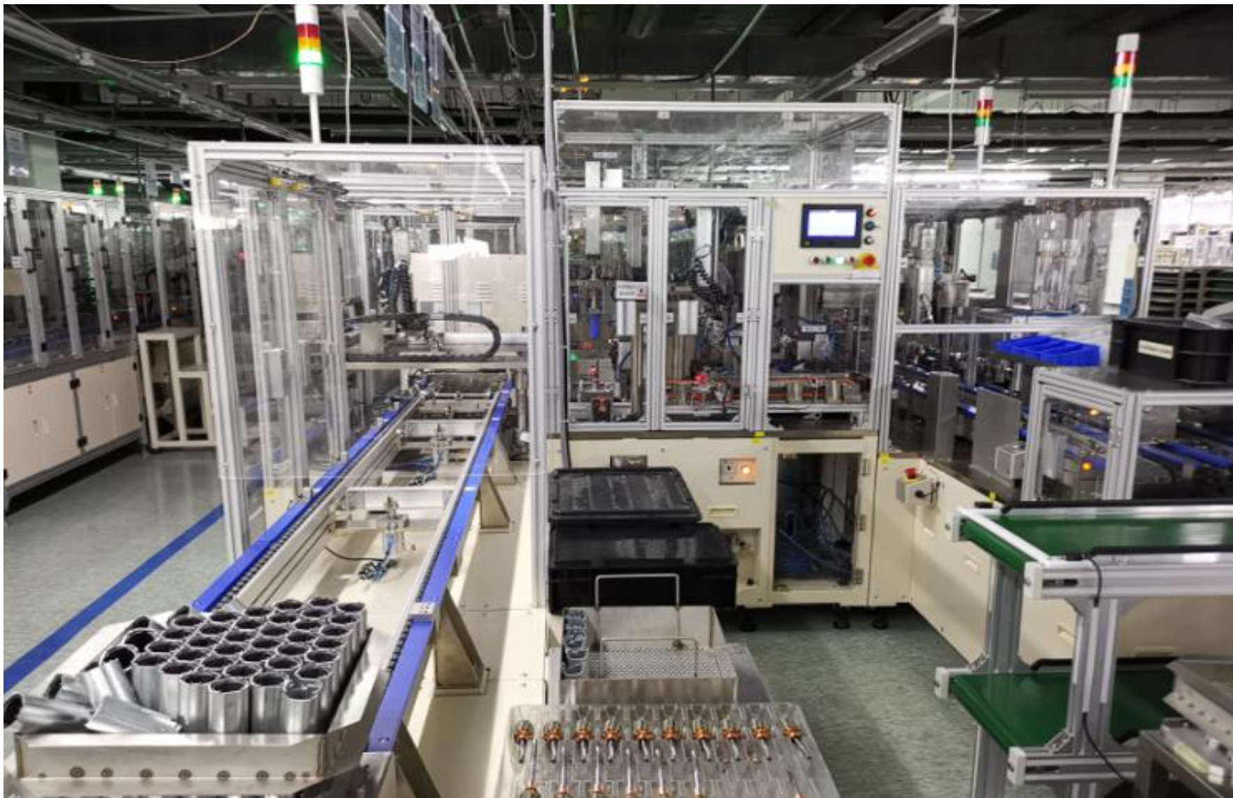
自动化组装生产线：在客户现场进行设备调试、验收。
